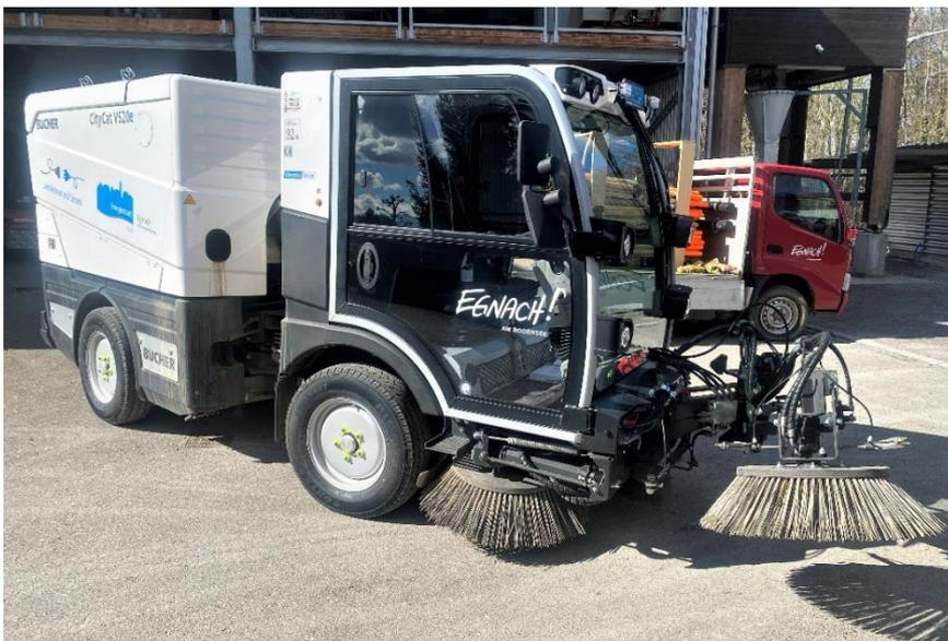
Egnach hat sich für eine Maschine mit einer etwas kleineren Batterie entschieden. Dies ergab Minderkosten um die Fr. 20'000. Über eine Schnellladestation mit 22kW Leistung kann die Maschine über Mittag wieder voll aufgeladen werden. Notabene mit eigenem Solarstrom vom Werkhofdach. Die Energiekosten sind somit fast bei null. Die Mehrkosten für die elektrische Version liegen heute bei ca. 30 Prozent, diese Mehrkosten amortisieren sich aber nach ca. 7 Jahren.
