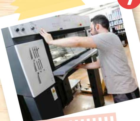
Jetzt gehts ans Drucken. Je nach Fröhdienst spannt Rocco Caldarola oder Francesco Caldarola die Metallplatten in der Druckmaschine auf einen Zylinder. Nachdem die Platten mit Wasser befeuchtet und mit Druckfarbe eingefärbt wurden, werden die Bildstellen auf einen Gummituchzylinder übertragen und von dort auf das Zeitungspapier gedruckt.
